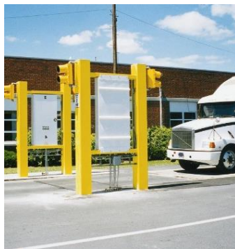
3.attēls Stacionārās radioaktivitātes līmeņa mēriekārtas (nosaka gamma vai gamma-neitronu starojumu)
