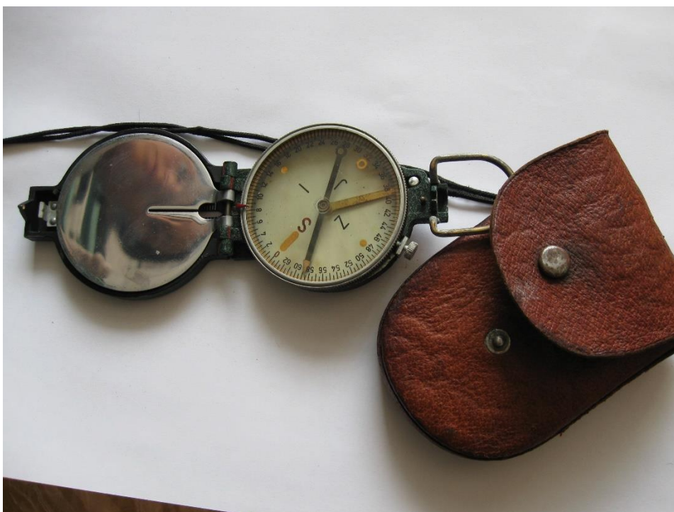
9.attēls. Kompass (2011. gads, robežšķērsošanas vieta Latvijā). Gamma starojuma dozas jaudas līmenis uz kompasa virsmas līdz 6,65 \mu\text{Sv/h} , identificēts radionuklīds Ra-226. Virsmas radioaktīvā nosmērētība netika konstatēta.
