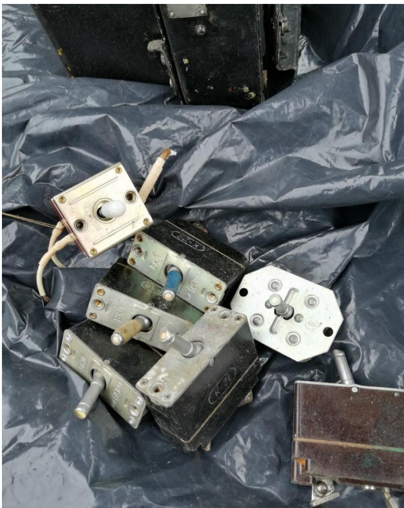
15.attēls. Slēdži, tumbleri ar radioluminiscējošu pārklājumu uz sviras gala (2021. gads, Rīga), identificēts radionuklīds Ra-226. Uz virsmas tika konstatēta alfa ( \alpha ) daļiņu nosmērētība.
