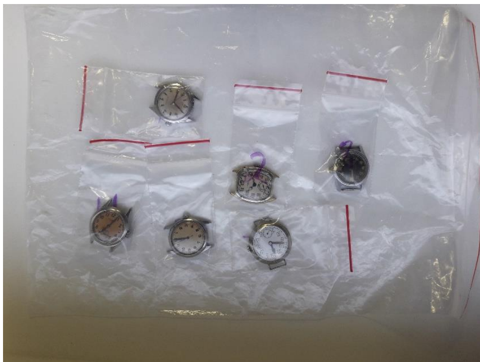
7.attēls. Rokas pulksteņi (2018. gads, robežšķērsošanas vieta Latvijā). Gamma starojuma dozas jaudas līmenis uz pulksteņu virsmas līdz 4 \mu\text{Sv/h} , identificēts radionuklīds Ra-226. Atsevišķiem pulksteņiem uz virsmas tika konstatēta alfa ( \alpha ) daļiņu nosmērētība.
