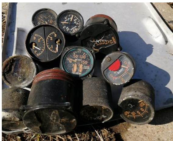
16.,17.attēls. Aviācijas mērinstrumenti (2021. gads, Rīga), identificēts radionuklīds Ra-226. Uz virsmas tika konstatēta alfa ( \alpha ) daļiņu nosmērētība.
