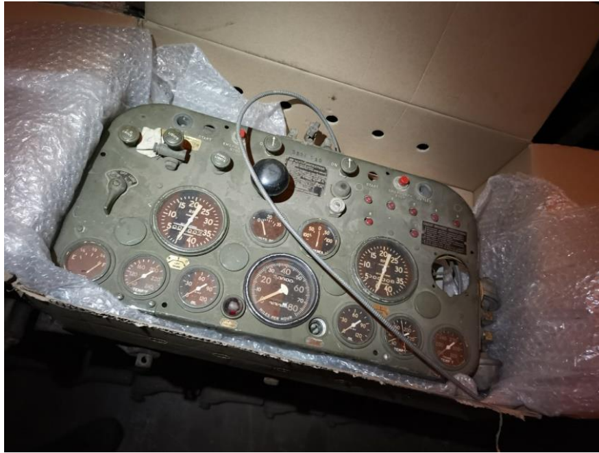
13.attēls. "Sherman" tanka vadības panelis, militāri vēsturisks priekšmets. (2019. gads, robežšķērsošanas vieta, Latvija). Gamma dozas jaudas līmenis uz virsmas līdz 30 \mu\text{Sv/h} , identificēts radionuklīds Ra-226. Virsmas radioaktīvā nosmērētība netika konstatēta.
