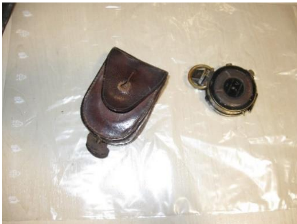
8.attēls. Kompass (2015.gads, robežšķērsošanas vieta Latvijā). Gamma starojuma dozas jaudas līmenis uz virsmas līdz 20,6 \mu\text{Sv/h} , identificēts radionuklīds Ra-226. Virsmas radioaktīvā nosmērētība netika konstatēta.
