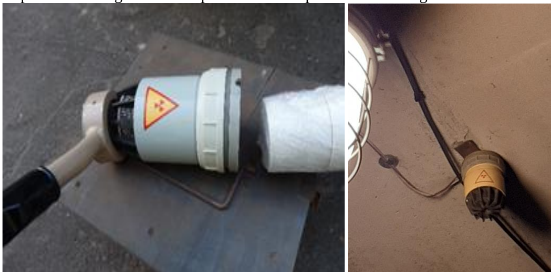
21., 22.attēli. Am-241 saturoši dūmu detektori RID-1 (РИД-1). Gamma dozas jaudas līmenis uz virsmas konstatēts līdz 10,6 \mu Sv/h, identificēts radionuklīds Am-241. Virsmas nosmērētība netika konstatēta.
