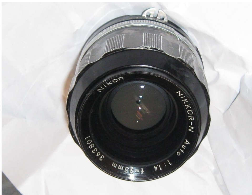
28.attēls. Fotoaparāta objektīvs (2014. gads, robežšķērsošanas punkts, Latvija). Gamma dozas jauda uz virsmas līdz 2,10 \mu\text{Sv/h} , identificēts radionuklīds torijs (Th-232). Virsmas radioaktīvā nosmērētība netika konstatēta.
