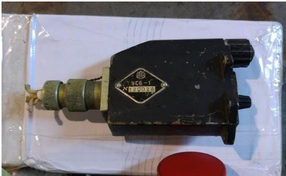
14.attēls. Militārā helikoptera tehniskā ierīce USB-1, atlikušo patronu skaitītājs (2016. gads, robežšķērsošanas vieta, Latvija). Gamma dozas jauda uz virsmas līdz 11,5 \mu\text{Sv/h} , identificēts radionuklīds Ra-226. Virsmas radioaktīvā nosmērētība netika konstatēta.
