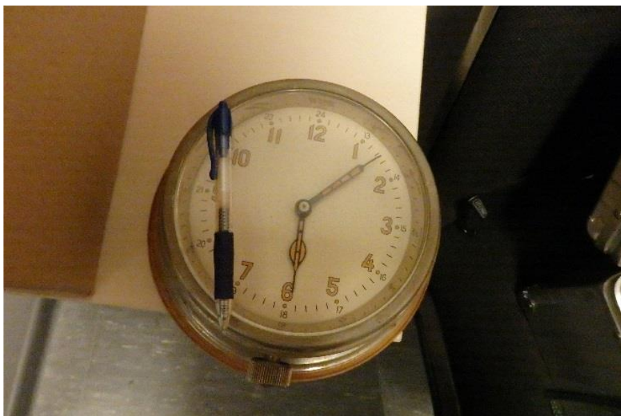
6. attēls. Kuģa pulkstenis (2018. gads, robežšķērsošanas vieta Latvijā). Gamma starojuma dozas jaudas līmenis uz kuģa pulksteņa virsmas līdz 7,8 \mu\text{Sv/h} , identificēts radionuklīds Ra-226. Virsmas radioaktīvā nosmērētība netika konstatēta.
