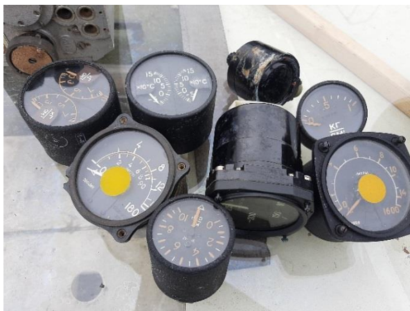
16.,17.attēls. Aviācijas mērinstrumenti (2021. gads, Rīga), identificēts radionuklīds Ra-226. Uz virsmas tika konstatēta alfa ( \alpha ) daļiņu nosmērētība.
