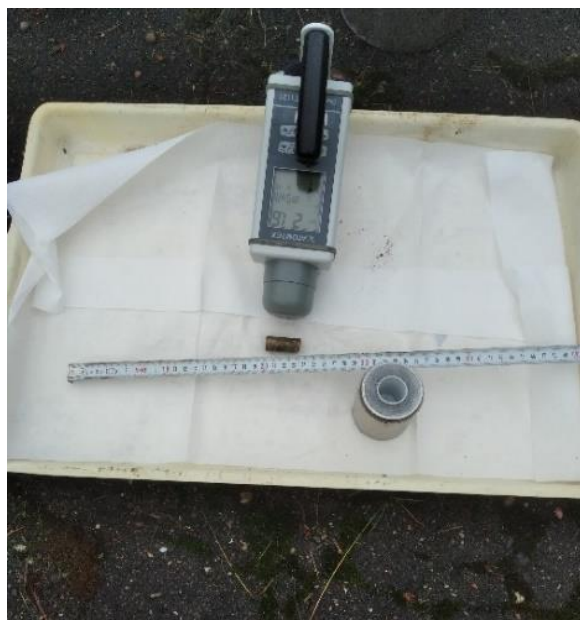
20.attēls. Slēgts cēzija Cs -137 avots (2020. gads, Rīga, metāllūžņu pieņemšanas punkts). Gamma dozas jauda 10 cm attālumā 2,1 mSv/h, identificēts radionuklīds Cs-137). Virsmas radioaktīvā nosmērētība netika konstatēta.
