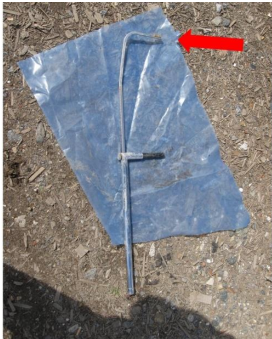
19.attēls. Cēzija avots (2015. gads, Rīga, metāllūžņu pieņemšanas punkts). Gamma dozas jauda uz virsmas līdz 1,8 \text{ mSv/h} , identificēts radionuklīds Cs-137. Virsmas radioaktīvā nosmērētība netika konstatēta.
