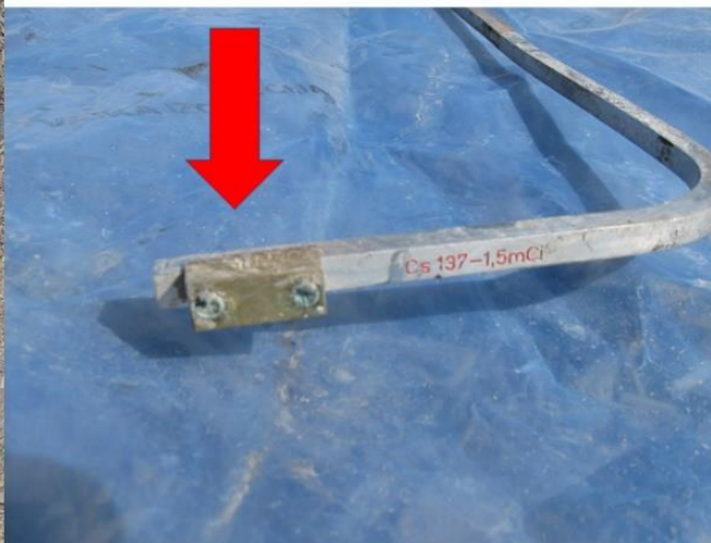
19.attēls. Cēzija avots (2015. gads, Rīga, metāllūžņu pieņemšanas punkts). Gamma dozas jauda uz virsmas līdz 1,8 \text{ mSv/h} , identificēts radionuklīds Cs-137. Virsmas radioaktīvā nosmērētība netika konstatēta.
