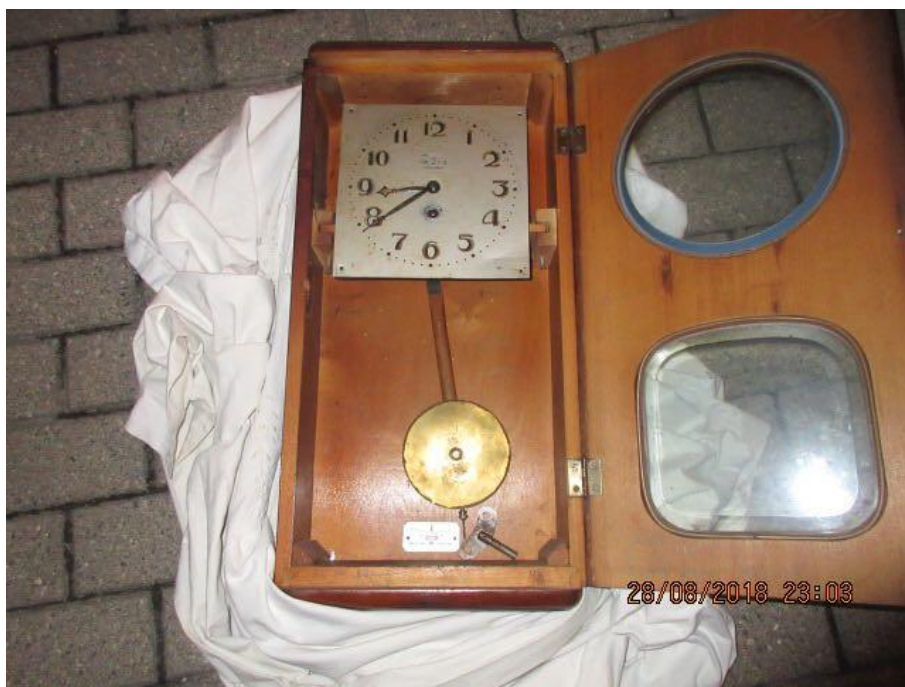
5. attēls. Sienas pulkstenis (2018. gads, robežšķērsošanas vieta Latvijā). Gamma starojuma dozas jaudas līmenis uz pulksteņa virsmas 5 \mu\text{Sv/h} , identificēts radionuklīds Ra-226. Uz virsmas tika konstatēta alfa ( \alpha ) daļiņu nosmērētība.
